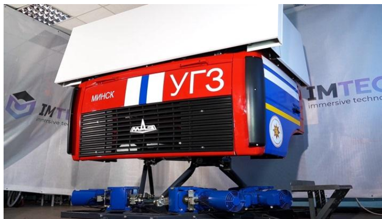
Рисунок 3 – Программно-аппаратный комплекс «Динамический автотренажер управления пожарной аварийно-спасательной техникой»
