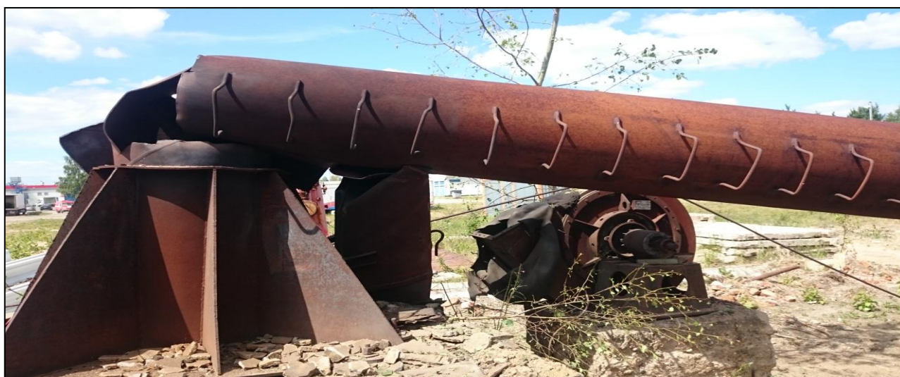
Рисунок 2 – Результат работы выполненного взрыва заряда ШКЗ,
