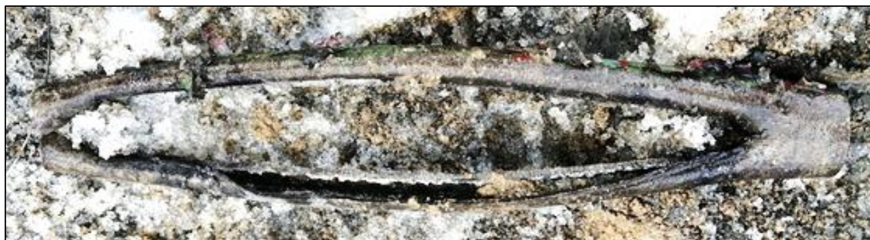
Рисунок 8 – Результат взрыва заряда ШКЗ, когда электродетонатор монтировался в прорезь непосредственно в торце шнура
