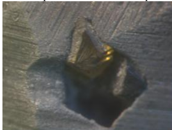
Рисунок 7 – Последние части кристалла и образовавшаяся лунка в металлической связке
