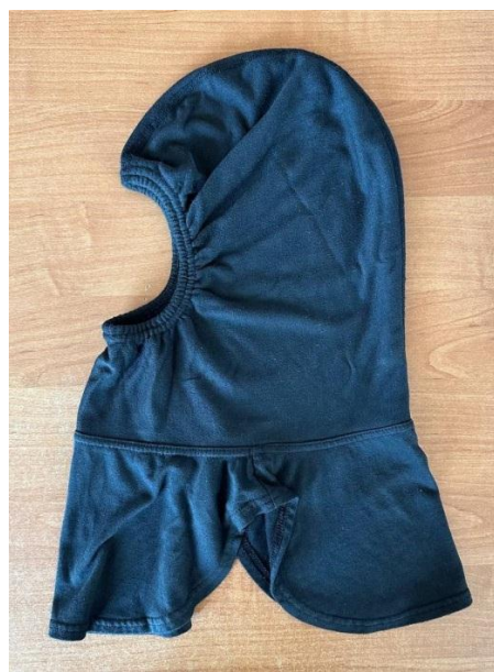
Рисунок 2 – Подшлемник с двумя слоями трикотажного полотна
