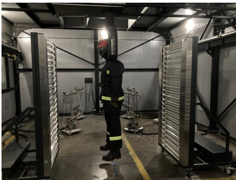
Рисунок 2. – проведение испытаний на испытательном комплексе «Термоманекен»
