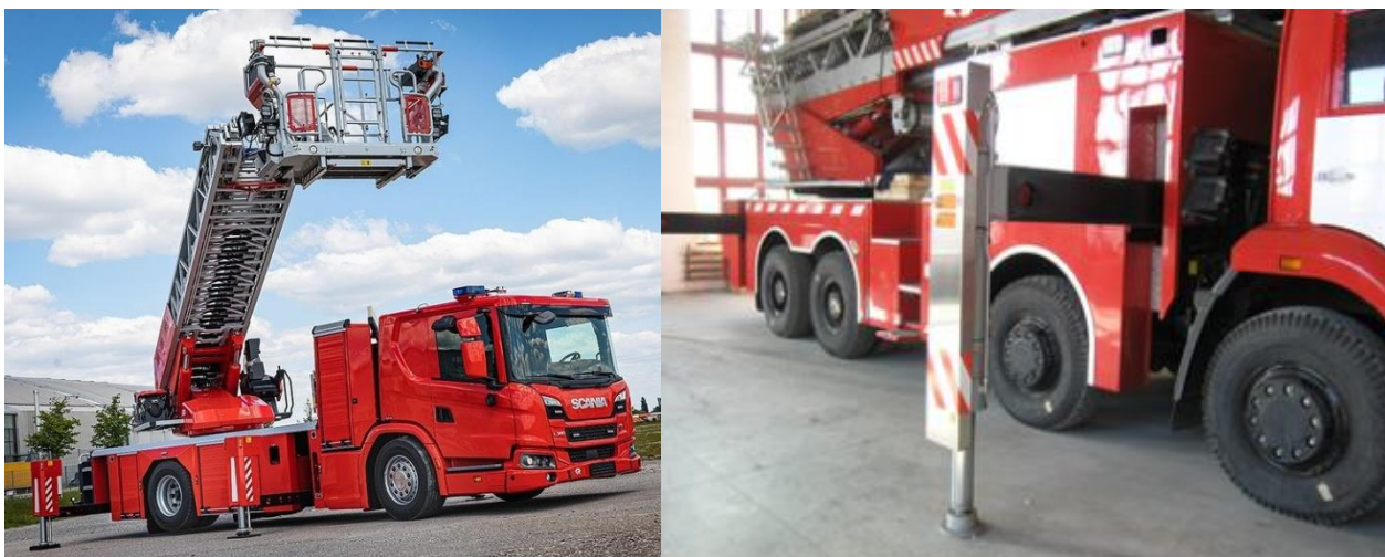
а – Rosenbauer International AG; б – АО «Варгашинский завод ППСО»; Рисунок 2. – Аутригеры Н-образного типа
