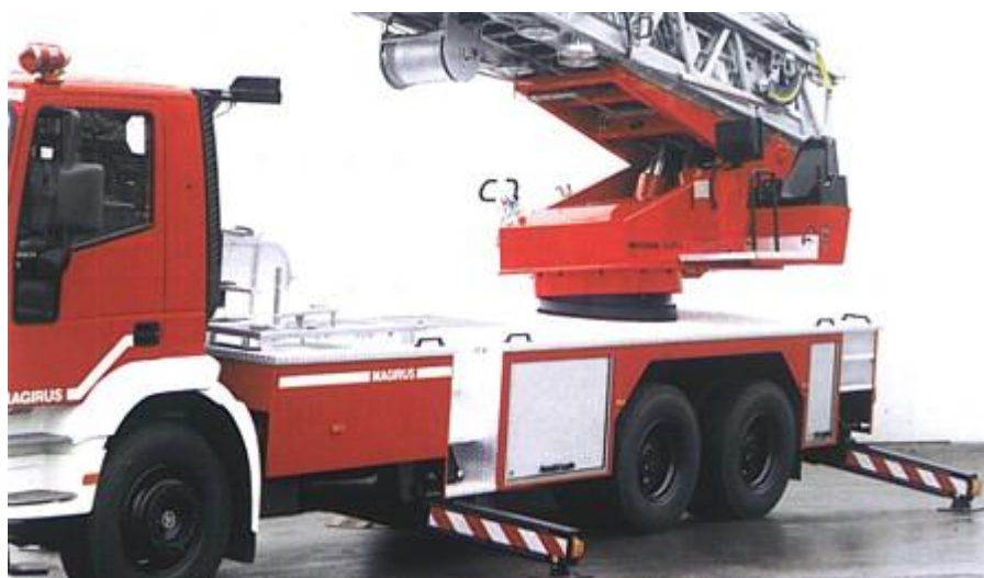
Рисунок 3. – Х-образные опоры IVECO MAGIRUS Brandschutztechnik GmbH
